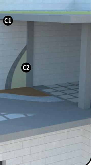
de trabajo y formar inmediatamente una base sólida de alta calidad para el acabado. A la fábrica se aplica una fina capa de sólo 3-5 mm de enlucido (yeso) BAUBLOCK®, seguida de un acabado decorativo.
